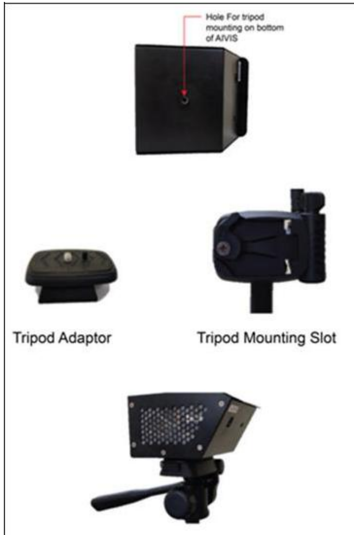
圖 4：在三腳架上安裝 AIVIS
